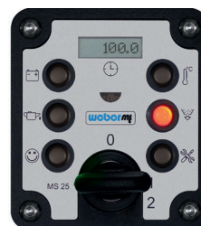
При загрязнении фильтра двигатель отключается через 10 мин.
